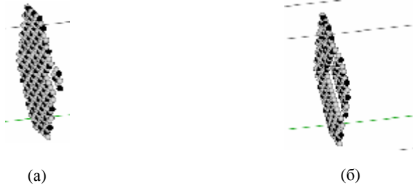
Рис. 9. Перестройка атомов плоскостей семейства \{111\} на 38 пс вблизи захвата (а) и в центральной области нановолокна (б) с одиночной внедренной САФГ \frac{1}{2}\langle 110 \rangle\{111\} при температуре 300 К
